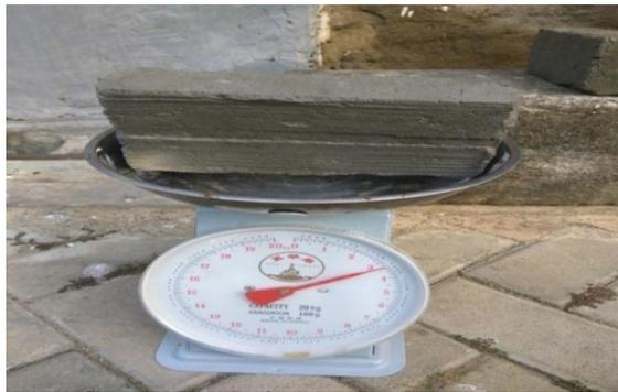
Gambar 4. Pengujian berat beton basah
