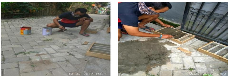
Gambar 2. Proses Pembuatan Paving Block
